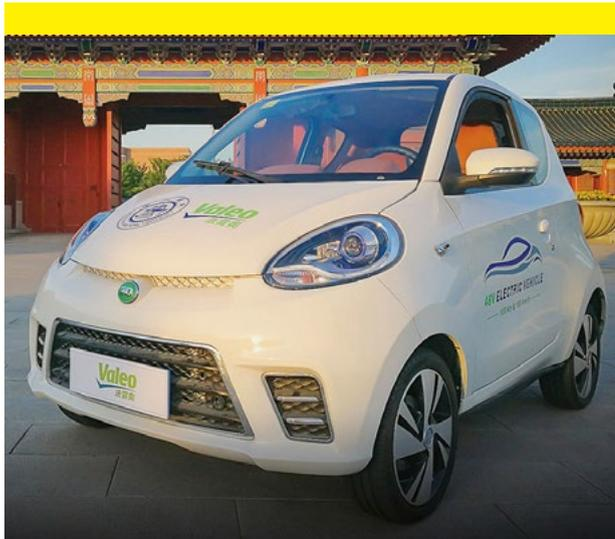
■ Au CES de Las Vegas comme à Vivatech Paris, Valeo a présenté un prototype de véhicule 100 % électrique développé en Chine, fonctionnant à basse tension (48 V). Ce système de motorisation, 20 % plus économique que les solutions haute tension existantes, permet à un petit véhicule 2 places de disposer d'une autonomie de 100 km et d'atteindre une vitesse de 100 km/heure. Poids : 700 kg.
