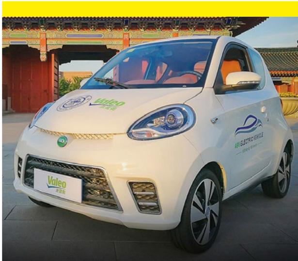
■ Au CES de Las Vegas comme à Vivattech Paris, Valeo a présenté un prototype de véhicule 100 % électrique développé en Chine, fonctionnant à basse tension (48 V). Ce système de motorisation, 20 % plus économique que les solutions haute tension existantes, permet à un petit véhicule 2 places de disposer d'une autonomie de 100 km et d'atteindre une vitesse de 100 km/heure. Poids : 700 kg.
